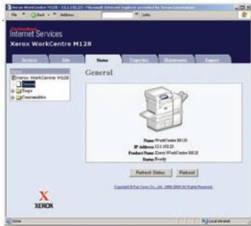
Um Servidor Web embutido (EWS) permite monitorar os trabalhos de impressão e o status de execução usando um navegador do PC. Os usuários podem definir as funções de impressão e fax a partir do PC. Os administradores de rede podem compreender melhor e prestar suporte às necessidades de impressão do escritório.
